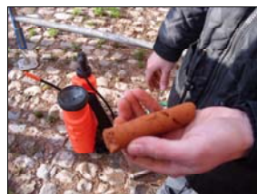
Fig. 3 : Echantillonnage de briques (en haut) et de mortiers (à gauche) dans les murs de la Ferme de l'Abbaye de Neufvilles, Belgique.
