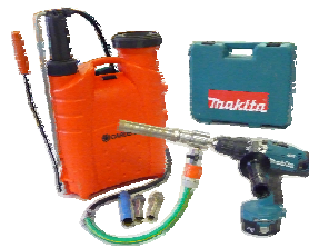
Fig. 2 : Système de carottage portatif.
